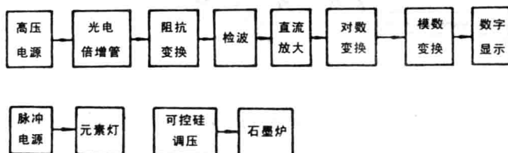
图 7-1-10 原子吸收分光光度计电气方框图
