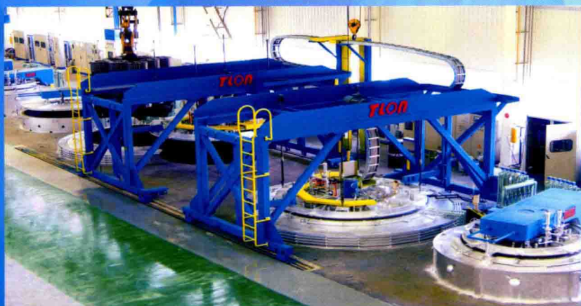
大型可控气氛井式渗碳炉生产线
