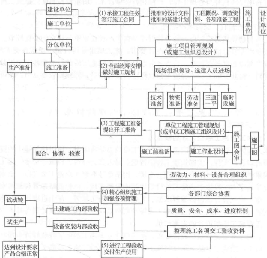
图 1-1 建设工程施工组织程序
