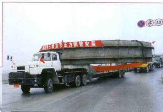
首节压力钢管运往安装现场
