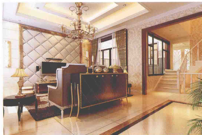
◎ 顶面 / 石膏板造型 + 灯带 电视墙 / 皮质软包 + 大理石线条收口
