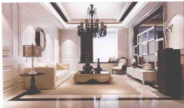
◎ 左墙 / 木饰面板凹凸装饰背景刷白 右墙 / 黑镜 + 实木线装饰框刷白
