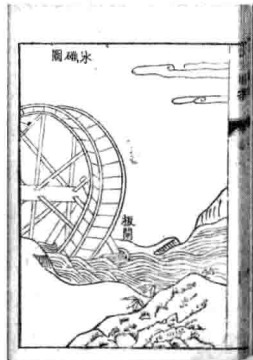
(a) 舂米机做功 (工作机) (b) 水轮获取能源 (原动机)
