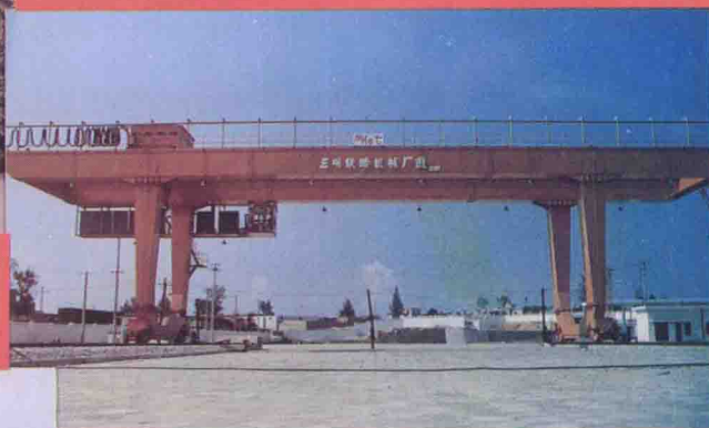
△“U”型 36/16t 通用型集装箱及笨重货物龙门起重机
