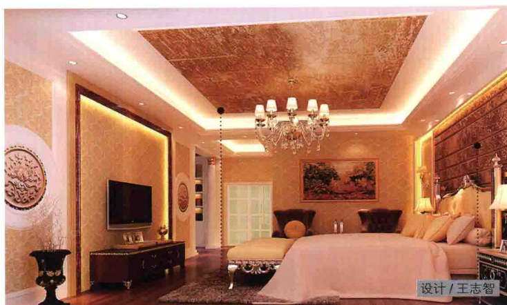
石膏板造型吊顶, 内贴金色壁纸
