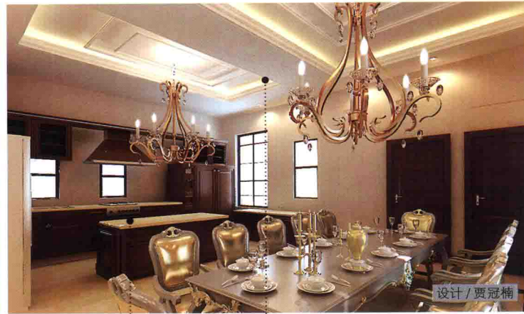
天然理石台面 石膏板分层造型吊顶附装饰石膏线
