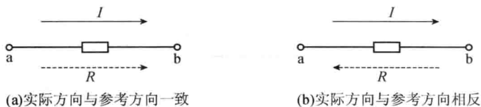
图 1-3 电流的实际方向与参考方向的关系
