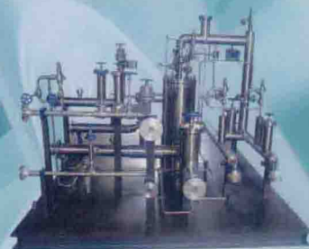
LNG 加气站泵池撬
