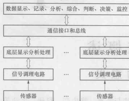
图 1-1 检测系统的基本结构框图
