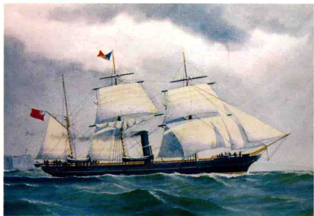
“舟山”号 (Chusan)，大英轮船公司最早的两艘铁质螺旋桨式轮船之一
