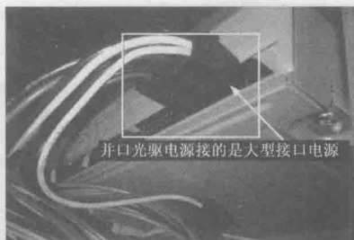
图 1-28 安装光驱电源
