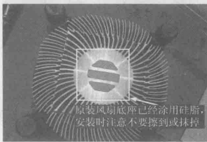
图 1-8 安装 CPU 风扇
