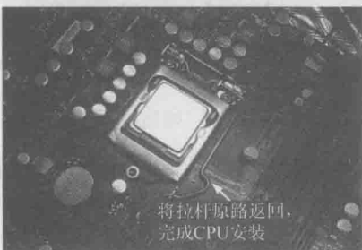
图 1-7 CPU 安装完成
