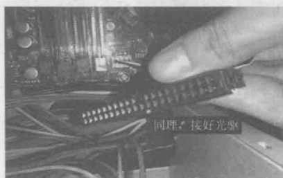
图 1-34 安装光驱数据线
