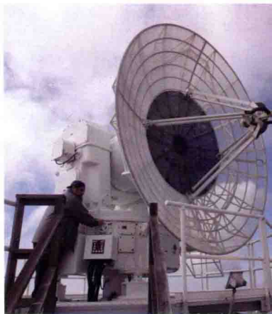
美国范登堡空军基地附近山顶上安装的 FPS-16 雷达, 海拔 648m, 主要用于跟踪在该基地起降的飞机, 也可用于跟踪弹道导弹
