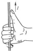
图 1-19 直导体电流产生的磁场
