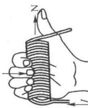
图 1-20 环形导体(线圈)电流产生的磁场
