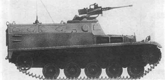
法国AMX-10P步兵战车（12.7毫米机枪型）
