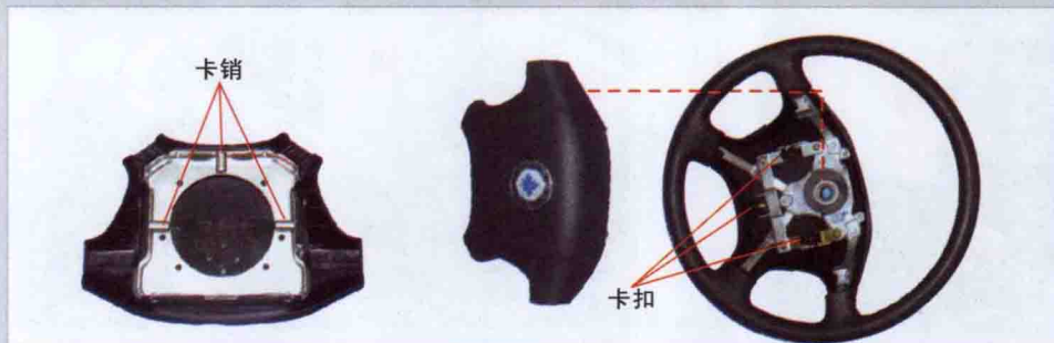
图3 拆下转向盘面罩
