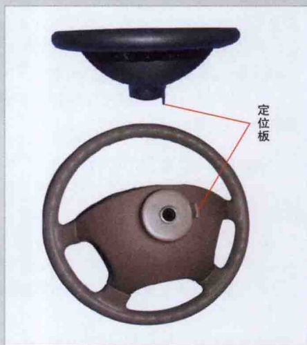
图2 转向盘定位凸板与定位槽安装
