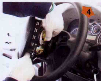
图2 转向盘定位凸板与定位槽安装
