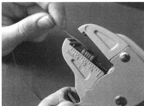
图 1-9 将导线放在剥线钳的钳口处
