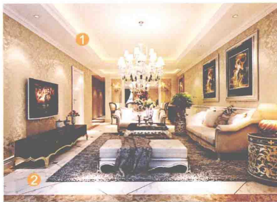
① 石膏板造型暗藏灯槽 ② 仿大理石地砖斜铺
