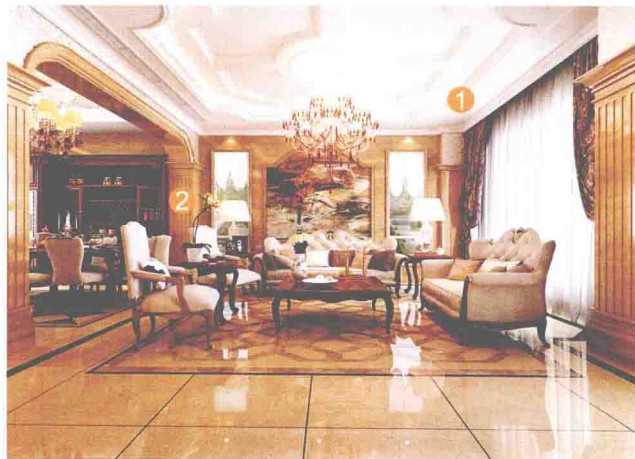
① 石膏板造型暗藏灯槽 ② 大理石罗马柱
