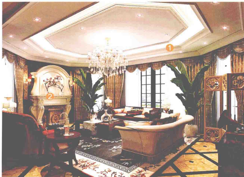
① 石膏板造型暗藏灯槽 ② 大理石壁炉造型
