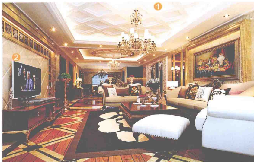
① 木线条打菱形框刷白 ② 米黄大理石倒 45° 角
