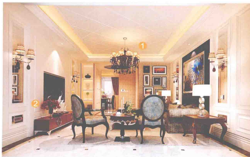
① 石膏板造型拓缝 ② 白色护墙板
