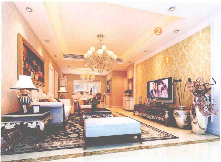
① 墙纸 ② 石膏板造型暗藏灯带
