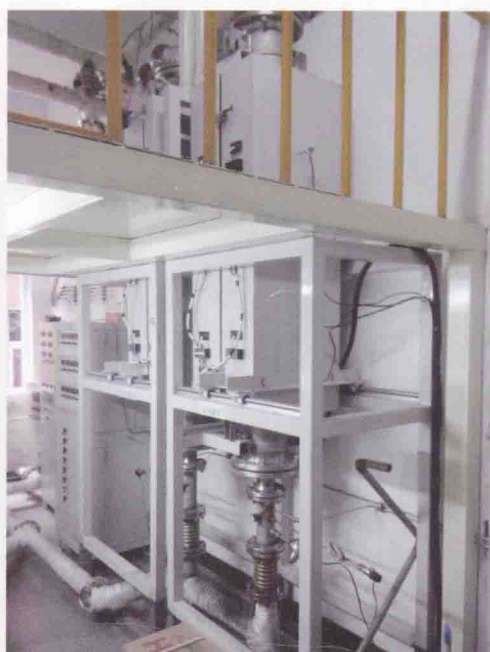
中科院过程工程所活性焦法脱硫脱硝小试实验台 ( 100\text{m}^3/\text{h} , 标志 )
