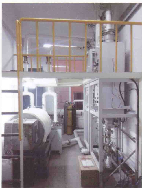
中科院过程工程所活性焦法脱硫脱硝小试实验台 ( 100\text{m}^3/\text{h} , 标志 )
