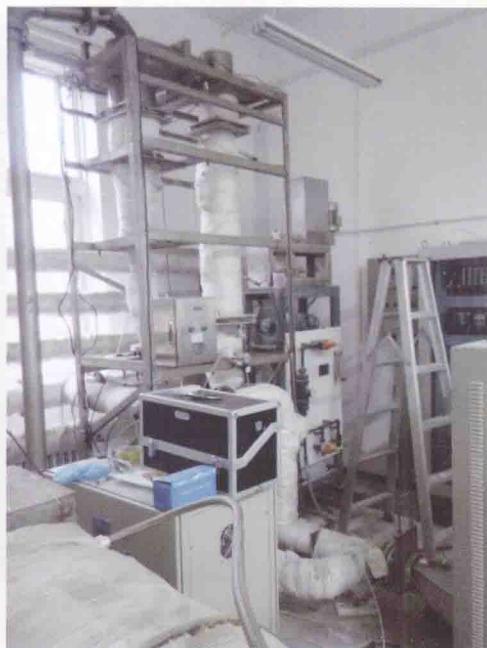
中科院过程工程所 IOCFB 多污染物协同控制小试实验台 ( 300\text{m}^3/\text{h} , 标志 )
