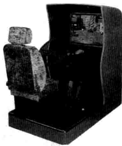
图1-5 采用虚拟现实技术生产的汽车驾驶模拟器
