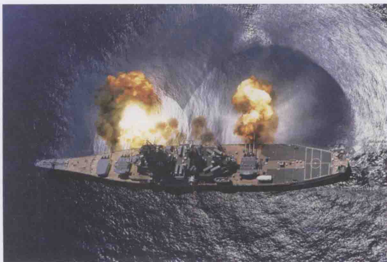
图0-2 大口径舰炮齐射时，膛口冲击波球形波阵面与火药燃气射流照片 [1]
