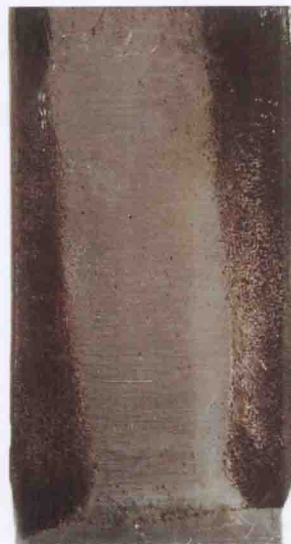
(b) 电解槽拆卸后取出的变形垫片
