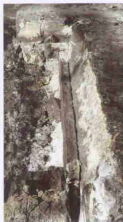
图6-34 底部炭块角部裂缝引起的电解槽破损, 炭块的上部已被移除, 露出了裂缝表面, 钢棒被部分熔化 槽寿命1032d
