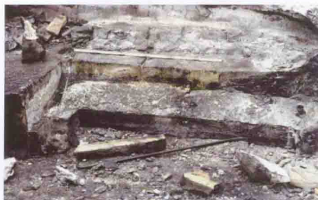
图6-37 阴极表面下面的一条从阴极钢棒槽口开始到捣固连接处结束的倾斜裂缝, 阴极钢棒和底部炭块的上部已被移除 槽寿命595d
