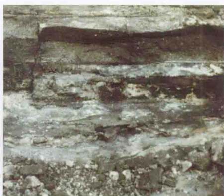
图6-12 严重的电流分布不均匀导致裂缝处阴极钢棒熔化和迅速石墨化以及底部炭块在电流路径上断裂。槽寿命2.5h（电解质通过阴极钢棒处流出）
