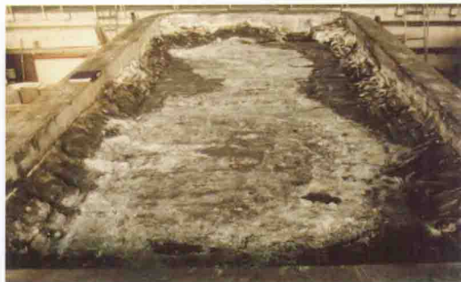
图6-11 清理好的阴极表面表明没有经过铣削加工的自焙阳极焙烧后加热很不均匀（在槽中间部分几乎没有加热），槽寿命2.5h
