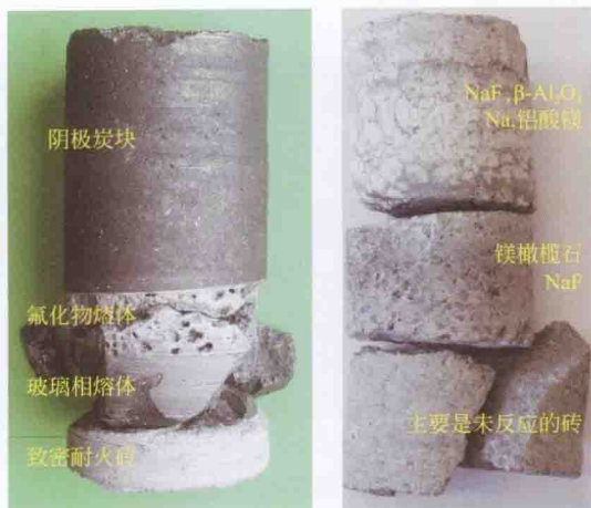
(a) 新型黏土砖的测试，在该部位形成了玻璃相防渗层（在电解槽运行300d时检查和修补）
