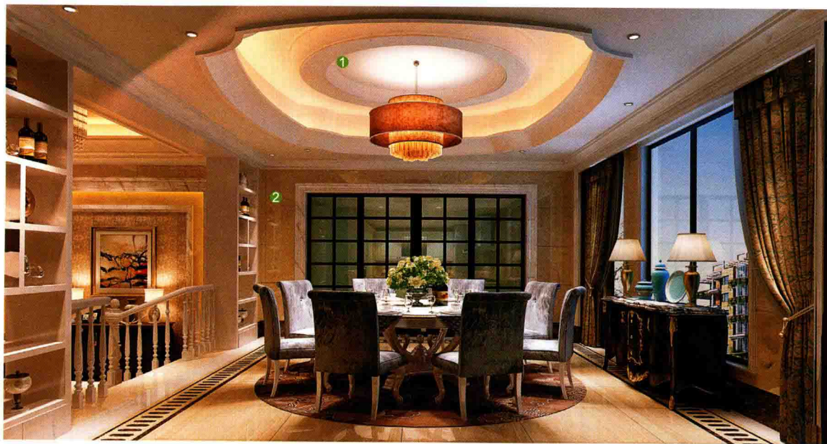
① 石膏板吊顶暗藏灯槽 ② 米黄色墙砖
