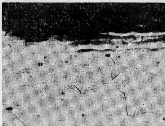
图 2—1 SUS33塔顶挂片 250 × 轻微晶蚀
