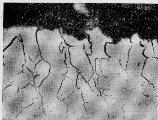
图 2—7 A 4 + A 4 焊缝塔顶挂片 1000× 无晶蚀、无选蚀
