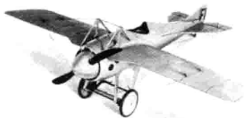
图1.2.8 第一架硬壳式单翼机德佩迪桑
