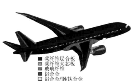
图1.2.12 波音787客机中的复合材料部件
