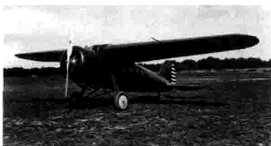
图1.2.10 首架半硬壳式结构飞机“织女星”
