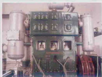
2000~2400m³/h 系列氧气压缩机 200~2400m³/h Series Oxygen Compressor
