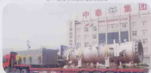
乙烯装置冷箱及塔顶冷凝器发运
