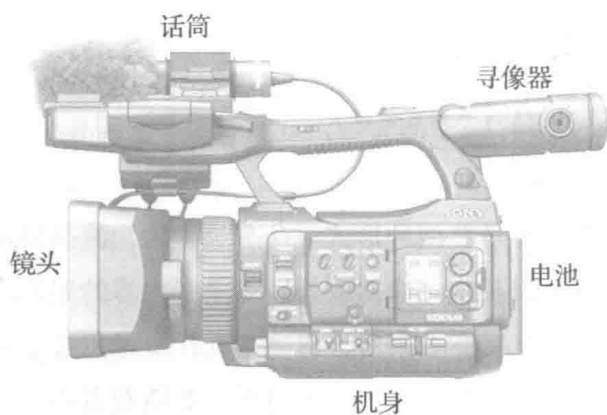
图 1-4 摄像机基本组成 (索尼 PMW-EX160)
