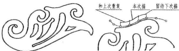
图 1-7 曲线板的用法
