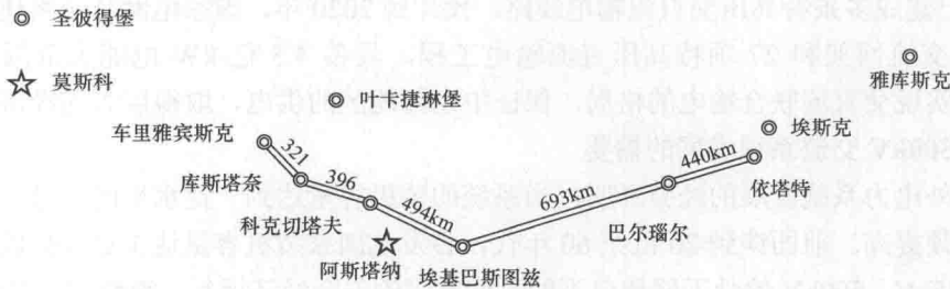
图 1-1-7 苏联 1150kV 特高压线路接线图
