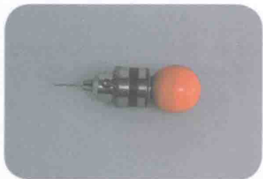
手钻： 在做创意手链、项链时，使用手钻可以为做好的水晶滴胶作品钻孔。
