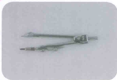
圆规： 圆规在数学和制图里，是用来绘制圆或弧的工具，常用于尺规作图。在本书中多用来画圆。
