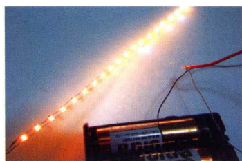
13 接上3V電箱，測試LED燈會否發亮。
