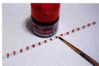
12 用橙色透明模型油塗在LED燈上，讓原為白色的LED燈改為橙色。
