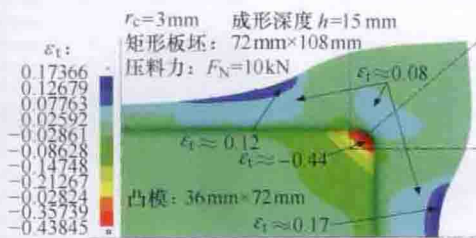
图 7-59 法兰板厚变形的有限元模拟结果
