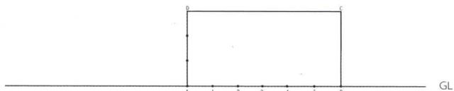
1. 绘制后墙面，假设房间高度为 3m、宽度为 6m、景深为 5m，按照比例绘制出后墙面矩形 ABCD，且 A、B 两点在基线（GL）上。
