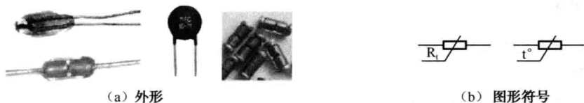
图2.6 热敏电阻的外形及图形符号
