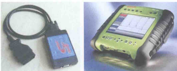
图1 OBD系统的故障诊断仪
