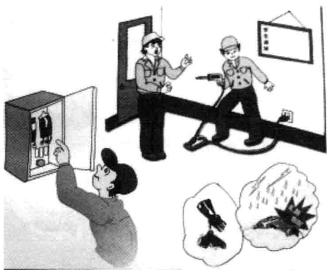
图1-7 违反“一机一闸一漏一箱”的规定
