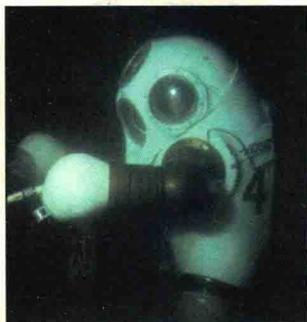
吉姆潜水服（上图）可以保护潜水者不受海水挤压，使他们能够深入2000英尺（约600米）甚至更深的海底。
