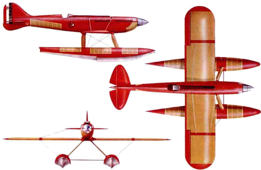
▲ 战前意大利航空技术的杰出成就——马基M.C.72竞速机。与最初的M.C.39相比，在机体外形尺寸相近的情况下，M.C.72发动机功率提高了一倍多（由1350马力提高到2850马力），但速度却没有得到相应程度的提高（由412.3km/h提高到709km/h）。
