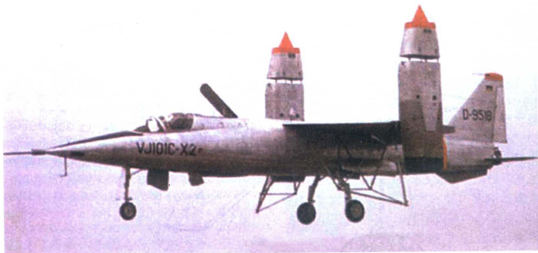
▲ 德国的 VJ101C 垂直起降验证机。它采用的是旋转发动机加固定升力发动机的布局，美国的 V-22“鱼鹰”也采用这种旋转发动机的布局，只是没有固定升力发动机。这种旋转发动机的布局缺陷不少，特别是控制律非常难以掌握，2 架 VJ101C 试验期间都出现过事故，美国的 V-22 也出现过几次重大事故。
