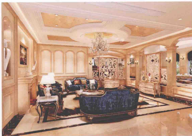
顶面 [石膏板造型 + 金箔墙纸] 右墙 [密度板雕花喷银漆 + 大理石罗马柱]
