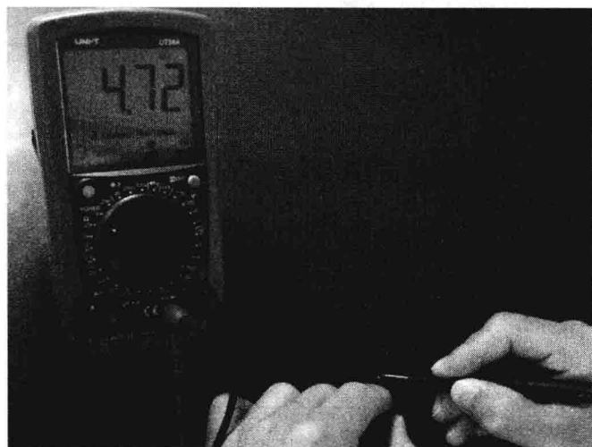
图 1-1-15 电阻测量方法
