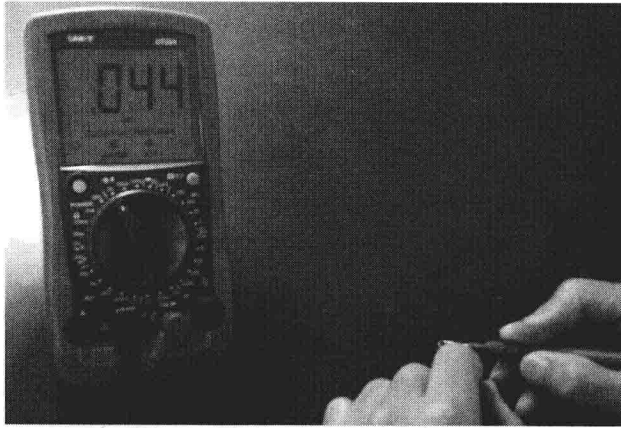
图 1-1-17 电容测量方法
