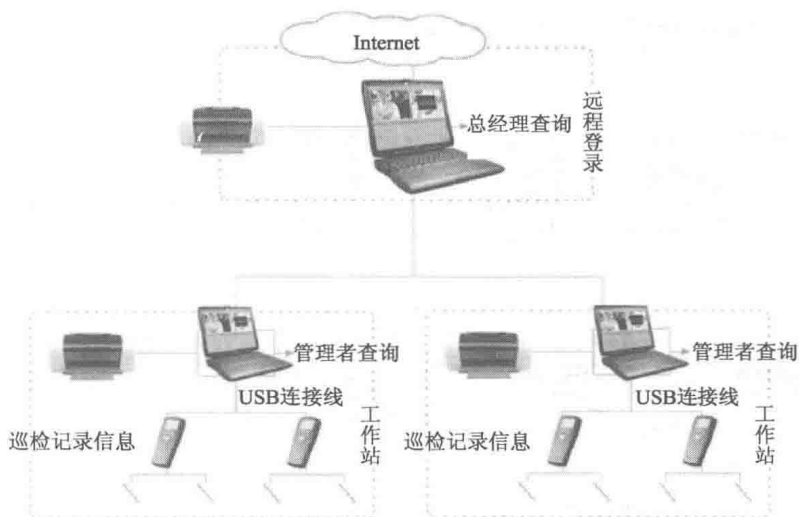
图 1-4 远程电子巡更系统示意图
