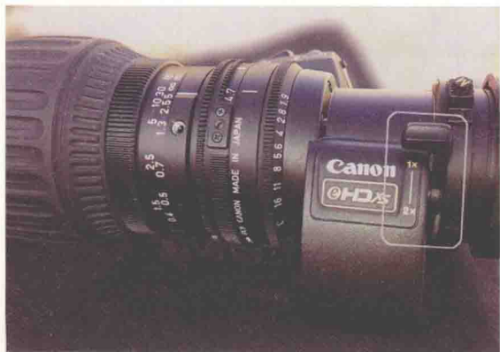
图1-16 变焦镜头上的焦距延长器
