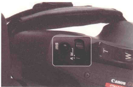
图1-9 自动、手动光圈切换开关
