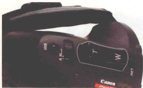
图1-6 变焦镜头把手上的电动变焦推拉杆
