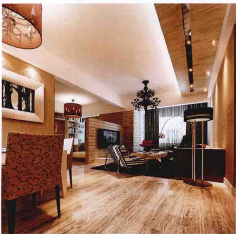
顶面 [木地板贴顶 + 灰镜]
