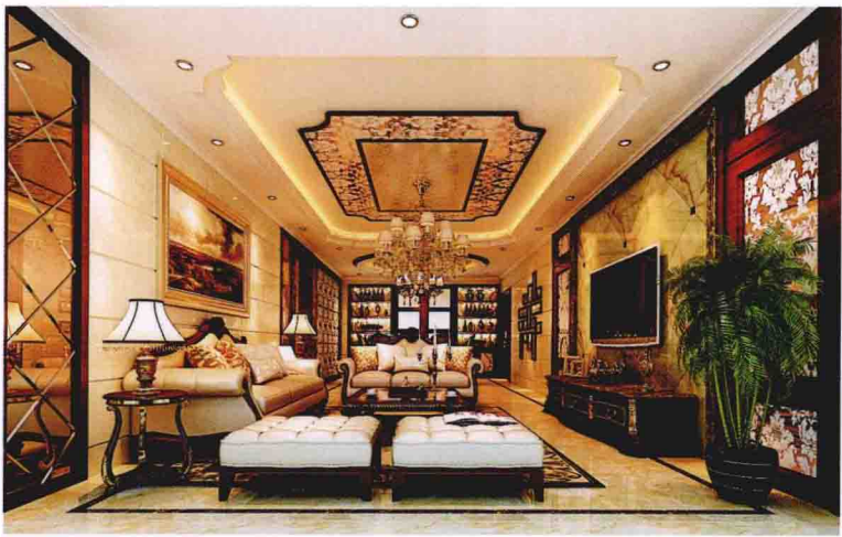
顶面 [ 墙纸 + 磨花茶镜 + 木线条收口 ]
