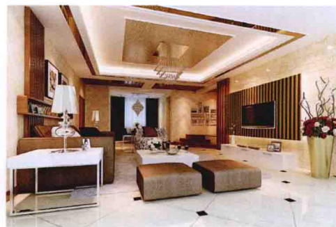
顶面 [ 石膏板造型 + 银镜 + 墙纸 ]
