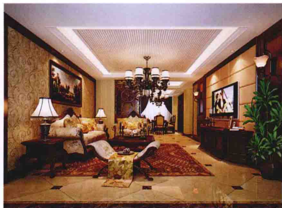
顶面 [ 石膏板造型 + 木线条密排 ]
