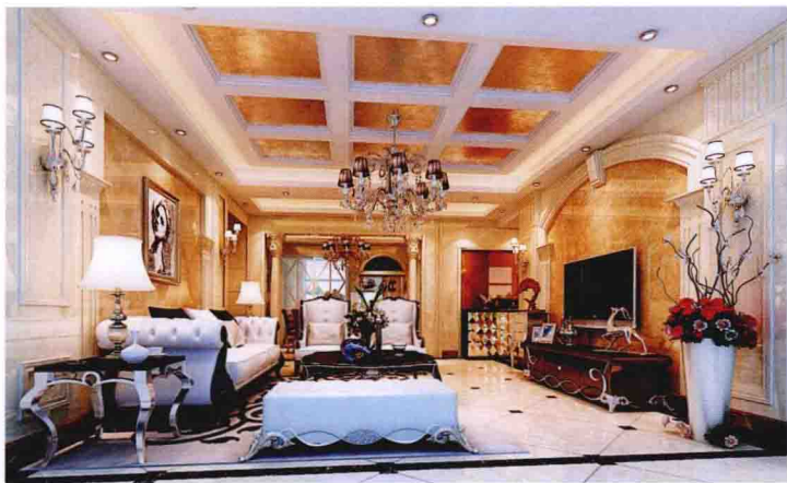
顶面 [石膏板装饰梁 + 银箔墙纸]
