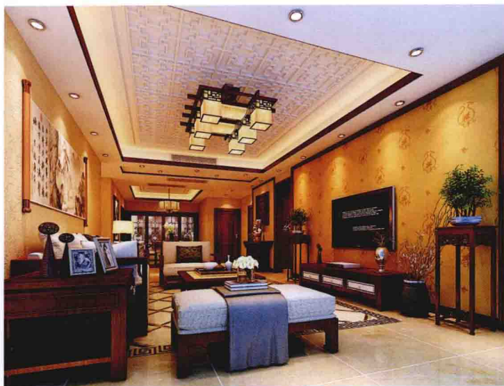
顶面 [ 中式木花格 + 木饰面板收边吊顶线 ]
