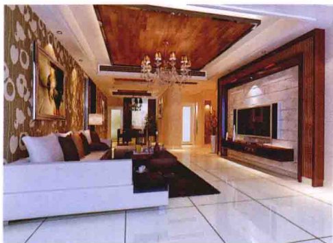
顶面 [ 木地板贴顶 + 不锈钢包边 ]
