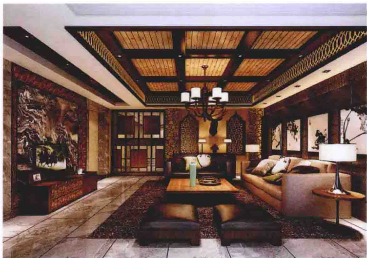
顶面 [杉木板吊顶 + 实木装饰梁 + 木花格]
