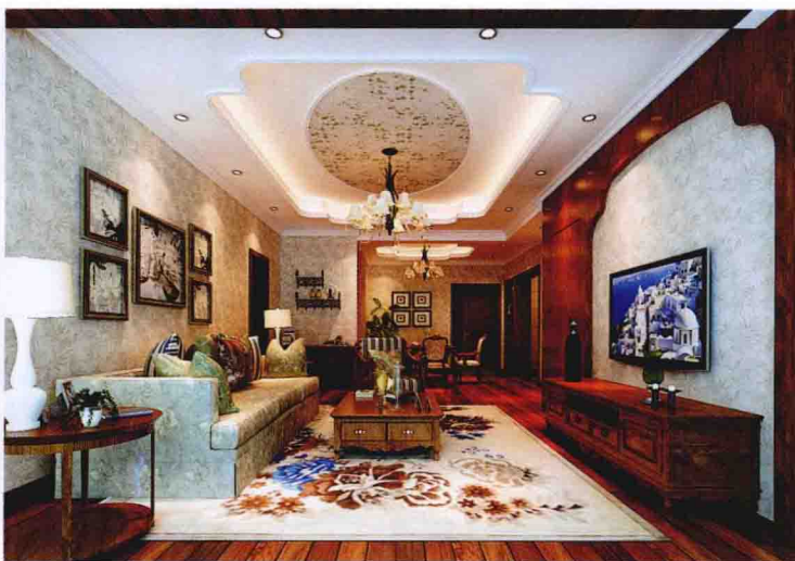
顶面 [石膏板造型 + 墙纸 + 木线条收口]
