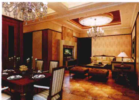
顶面 [石膏板造型 + 杉木板吊顶]
