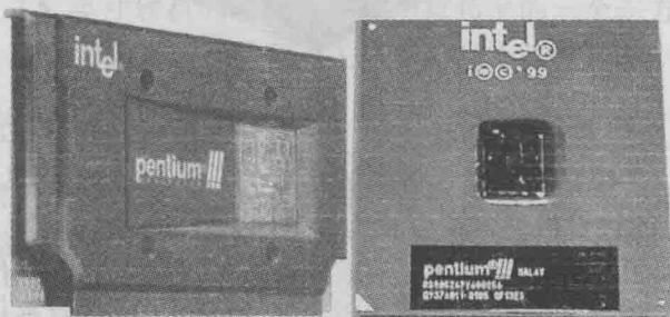
图 1-3 两种封装形式的 Intel Pentium III CPU
