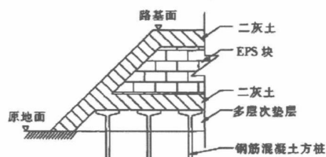
图 1.6 上海 F1 赛车场桩承式路堤构造
