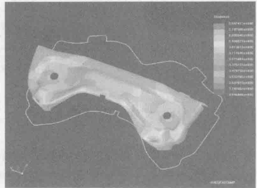
图 1-3 LS-DYNA 模拟板料成形
