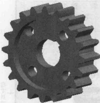
图 1.7 修改前齿数 20 的齿轮模型
