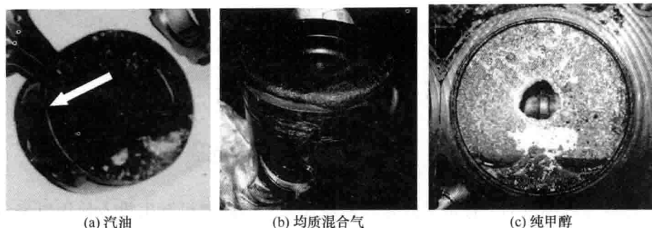
图 1-1 活塞被爆震损坏的情况
